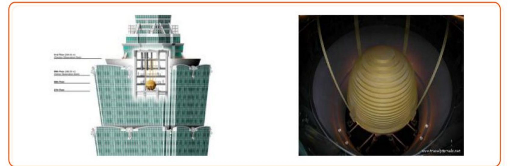
Figure 3. 동조질량감쇠기(TMD) 적용을 통한 제진설계
